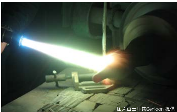
图24 向冲头顶端移动火焰
