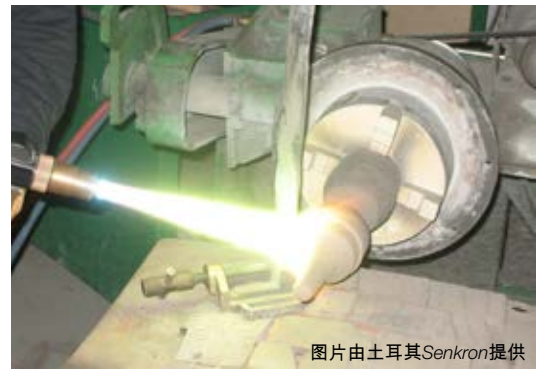
图21 正确喷涂条件
