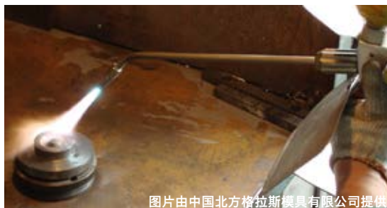
图19 薄涂层减少氧化
