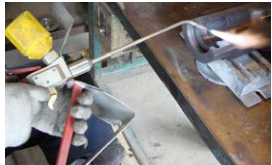
图16 成模边缘粉末喷焊
